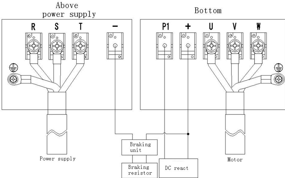
Fig. 2-7 3160G/3185P~3355G/3400P Main Circuit Wiring
