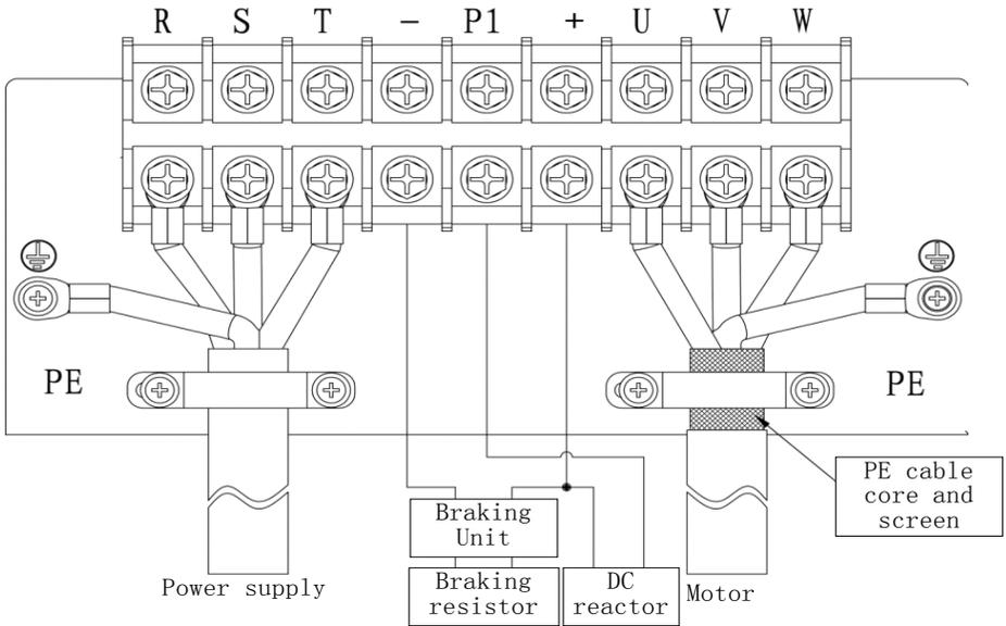
Fig. 2-6 3018G/3022P~3055G/3075P Main Circuit Wiring
